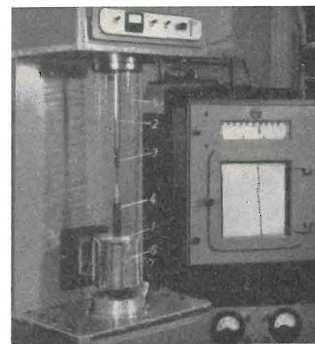
Apparecchiatura per la preparazione di germanio monocristallino; (1) crogiuolo contenente germanio fuso; (2) asse ruotante; (3) sostegno del germe di cristallo; (4) barra di germanio monocristallino. Il tutto è contenuto nel tubo di vetro (5) in cui circola del gas inerte. Il crogiuolo è circondato da spire opportunamente sagomate, raffreddate ad acqua, e percorse da correnti a radio frequenza. A destra si trova il registratore per il controllo automatico della temperatura di fusione. (Foto Philips)
